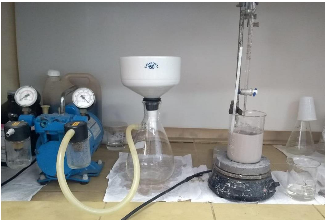
Figura 4 - Imagem do sistema utilizado para a produção de sulfato de magnésio heptahidratado
